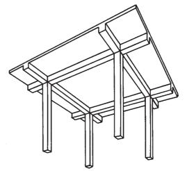
(d) Two-way slab with beams.
