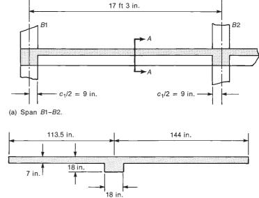
Fig. 13-36 Span *B*1–*B*2—Example 13-6.
